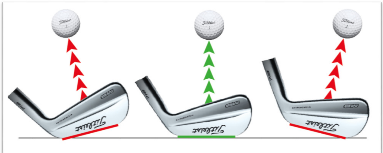
Abbildung 6 (v.l.n.r.): Spitze in der Luft, korrekter Lie bzw. Hacke in der Luft.
