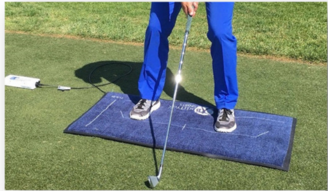
Abb. 14: Druckmessplatten gibt es als stationäre Einheit oder - wie hier abgebildet - als mobile Version. Ein mobiles Gerät hat den Vorteil, auf dem Golfplatz unter realen Bedingungen eingesetzt werden zu können (Bild: Boditrak Golf/All Square).
