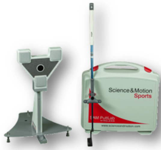
Abb. 15: Das SAM PuttLab untersucht ca. 30 Parameter der Puttbewegung per Ultraschall und ist auf 0,1 Grad genau (Bild: Science & Motion GmbH).
